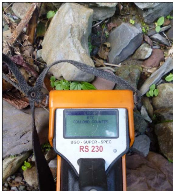
Figura 45. Equipo RS 230 utilizado para mediciones gamaespectrométricas de anomalías de U, Th y K
