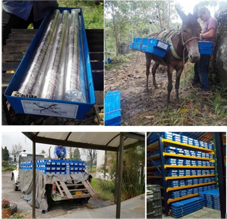
**Figura 42.** Disposición de núcleos de perforación en cajas para su transporte y entrega en la Litoteca del SGC en Bogotá (CAN)
