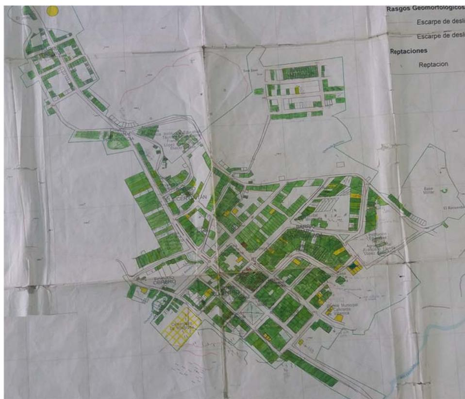
Figura 59 Avance en la toma de datos en campo para evaluación de vulnerabilidad física de viviendas. Verde: viviendas levantadas. Amarillo: viviendas en las que no se pudo ingresar. Blanco: viviendas faltantes.
