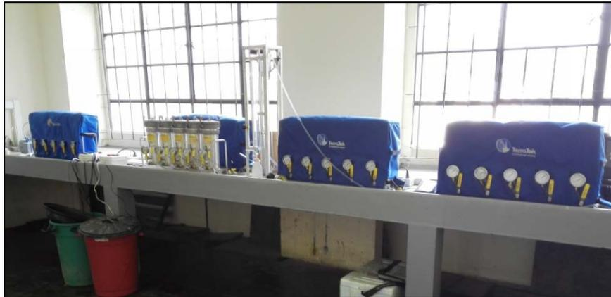
**Figura 43.** Disposición en el laboratorio, de los canister que contienen las muestras de carbón obtenidas en las perforaciones, para mediciones de contenidos de GMAC.
