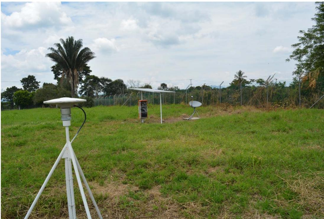
**Figura 102.** Estación geodésica GNSS con sistema de transmisión de datos vía internet satelital
