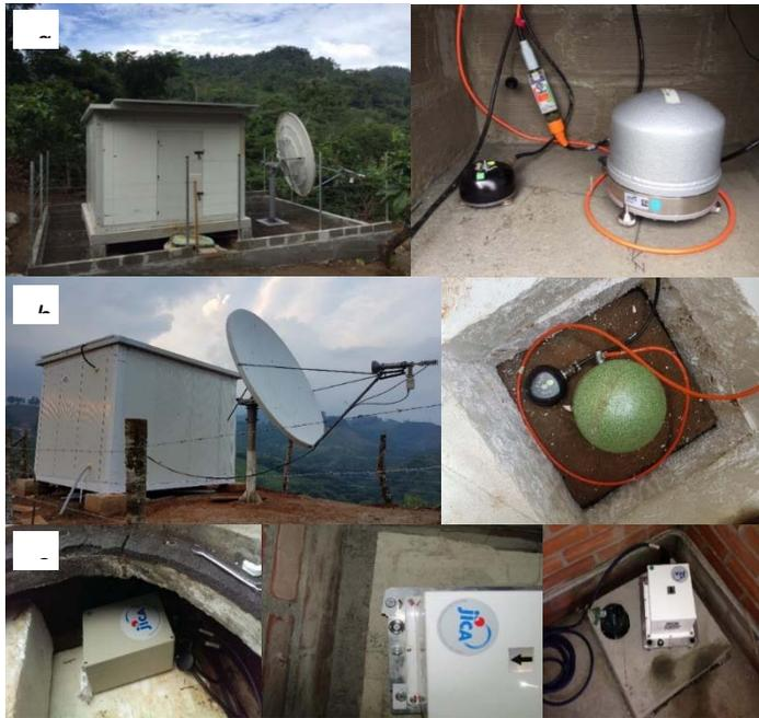
Figura 74. a) Estaciones de Apartadó – Antioquia, sensores de velocidad y aceleración, b) Estaciones de Jamundí - Valle del Cauca, sensores de velocidad y aceleración, b) Estaciones de Popayán, Punta Ardita y Villavicencio, sensores de velocidad de movimiento fuerte (de izquierda a derecha)
